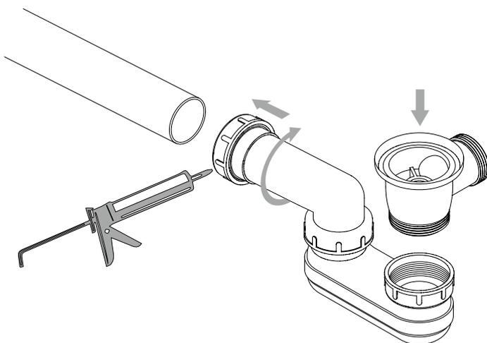
Cerciorarse de instalar juntas de estanqueidad en todas las conexiones de desagüe.
