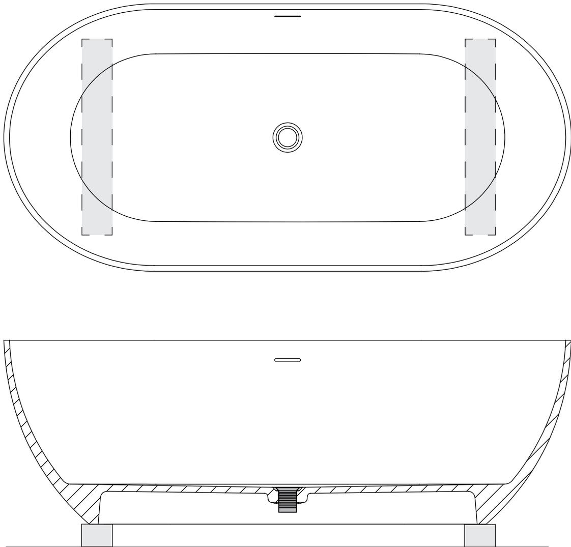
Dado que las bañeras en isla no cuentan con aberturas para revisión, deberá colocarse sobre dos vigas de maderas para instalarla. A continuación se debe proceder a conectar el sifón proporcionado (rosca de 1,5 pulgadas) al sumidero. Asegúrese de que la rosca esté colocada correctamente y derecha.
