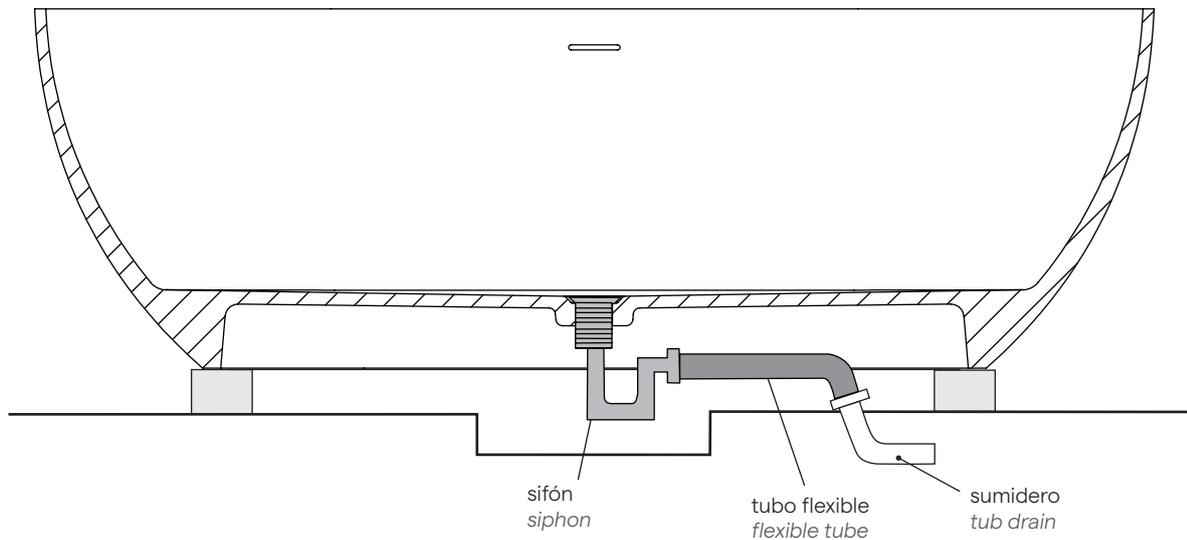
Para conectar de manera segura el sifón al sumidero se necesita un tubo flexible debido a la tirantez al descender la bañera a su posición final.
